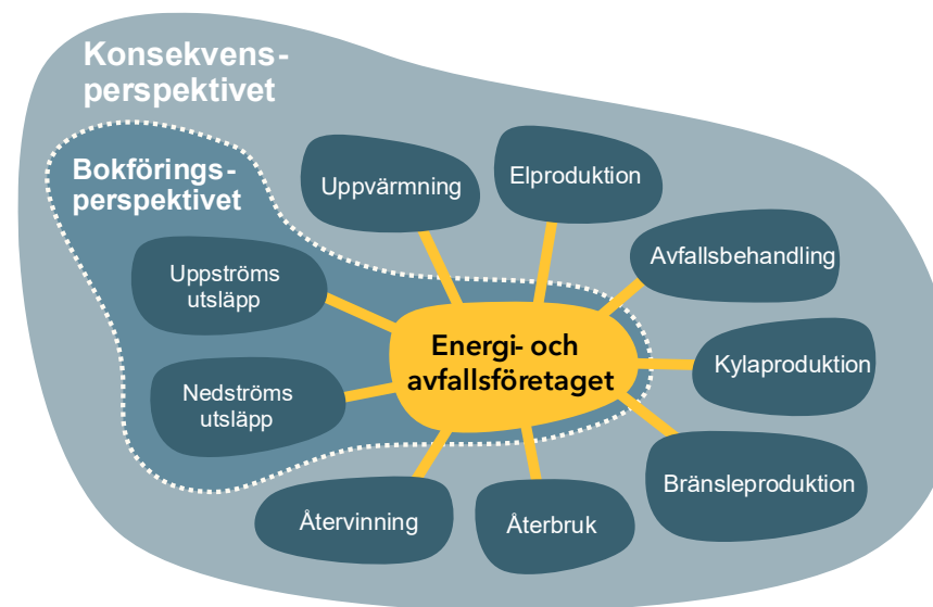
Figur 11 Skillnaden i systemgräns för konsekvens- och bokföringsperspektivet. Konsekvensperspektivet inkluderar företaget och hela dess omgivning. Bokföringsperspektivet inkluderar företaget och delar av omgivning men inte klimatpåverkan från undvikna alternativ till produktion tack vare företagets levererade produkter och tjänster.
